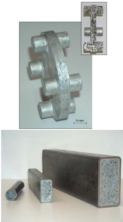
Şekil 2. Kalıp ve profil içerisinde köpürtülmüş Al köpükler [16,17]
