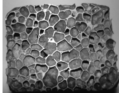
Şekil 1. Kapalı kalıpta üretilen Al esaslı metalik köpük
