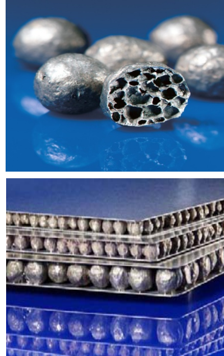
Şekil 3. Küresel metalik köpükler [18]
