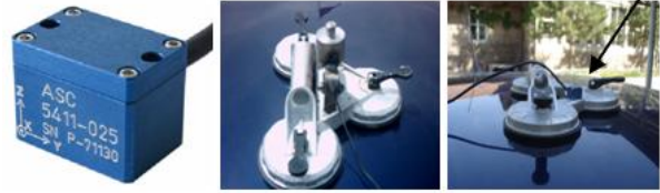
Şekil 2. İvme ölçer sensorunun araca montajı
