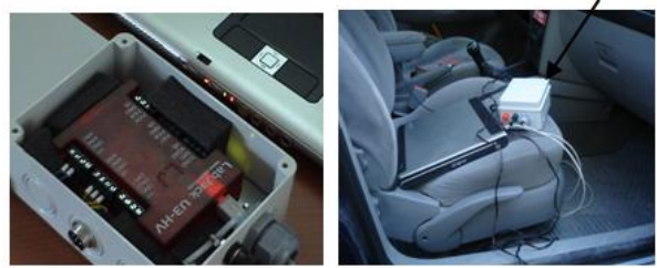
Şekil 3. U3 Veri aktarıcı genel görünüşü ve taşıt içindeki montajı
